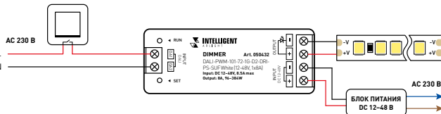
Рис. 3. Схема подключения диммера при управлении PUSH DIM
