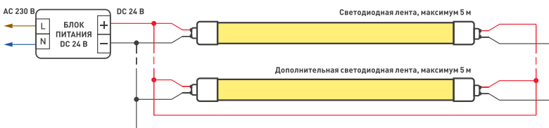
Схема 2. Подключение нескольких светодиодных лент «неон» с двух сторон. Рекомендуется использовать для обеспечения равномерного свечения ленты по всей длине.
